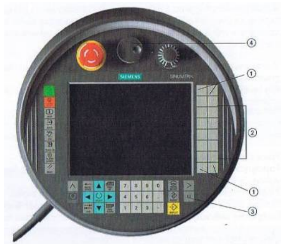
Rys.18 . Przenośny terminal: 1 - przyciski klienta (dowolnie konfigurowane), 2 - przyciski ruchu, 3 - przycisk menu użytkownika, 4- kółko ręczne (opcjonalnie)
