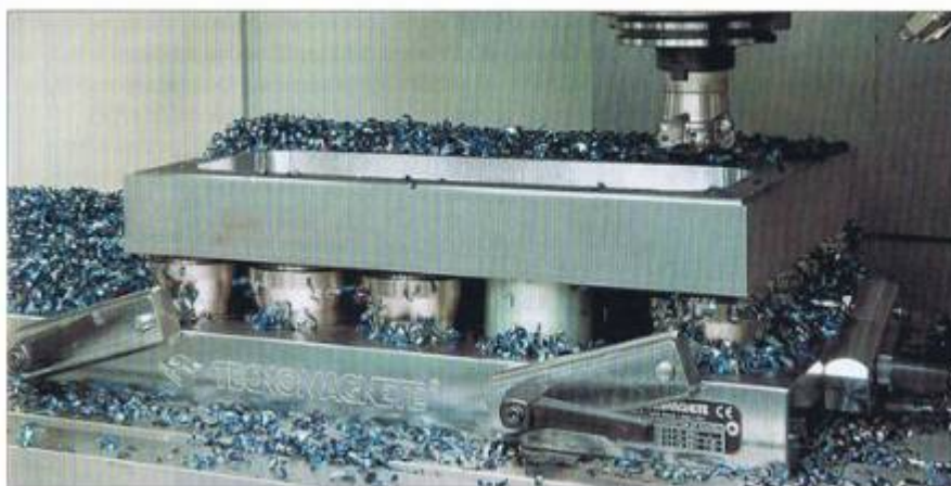
Rys.6 Przykład frezowania przedmiotu zamocowanego w uchwycie magnetycznym
