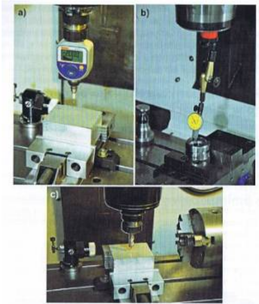
Rys. 3 Przykłady pomiarów ręcznych - wyznaczenie punktu zerowego przedmiotu: a) czujnikiem krawędziowym, b) czujnikiem dźwigienkowym, c) narzędziem
