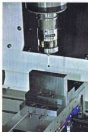
Rys. 4 Przykłady pomiarów automatycznych na frezarce - wyznaczenie punktu zerowego przedmiotu
